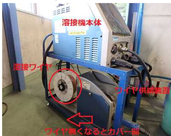
図4-1 機械(溶接機)全体図
