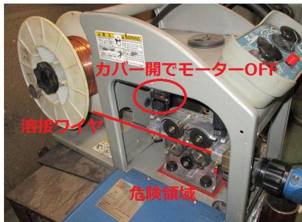
図4-2ワイヤ供給装置内部
