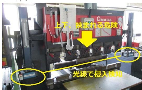
図4-3 プレスブレーキと光線式安全装置
